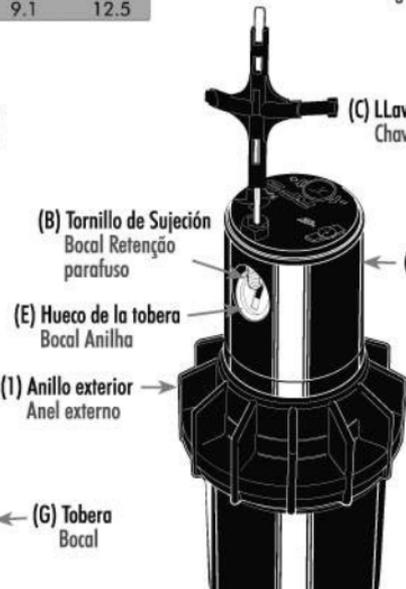
(B) Tornillo de Sujeción Bocal Retención parafuso
