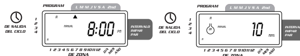
FIGURA 12: Riego manual ya sea en el programa A o en el B únicamente
