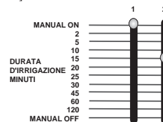
FIGURA 13: Graduador deslizante para la duración situado en Manual Off
