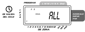
FIGURA 10: Riego semiautomático para las estaciones asignadas a los programas A y B
